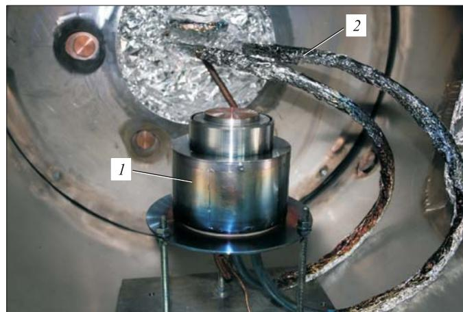
Рис. 1. Расположение MPC (1) с жидкокомпозитным катодом (2) в вакуумной камере
